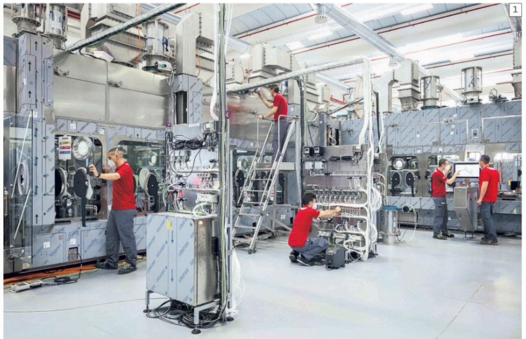
1 La linea isolata per la ripartizione in aseptico di prodotti iniettabili realizzata da Ima in uno dei suoi stabilimenti industriali
